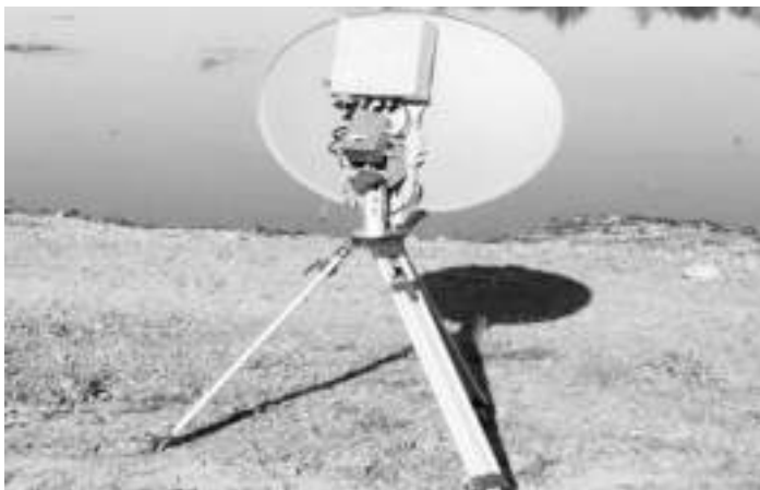
Рис. 13. Мобильный комплекс спутниковой связи (источник: «Форесткомплекс») [23]
